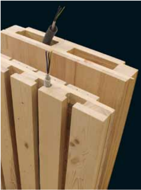
Bei den Lignotrend-Elementen (hier: Wandelemente) wird nur dort massives Holz eingesetzt, wo es aus technischer Sicht nötig ist. Wo es nicht notwendig ist, bleiben Hohlräume, die die Raumklimawirksamkeit verbessern und Installationen aufnehmen
